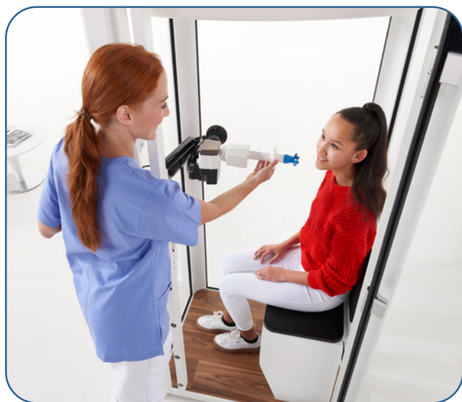
MicroGard® IIC met wegwerpmondstuk tijdens bodyplethysmografiemeting
